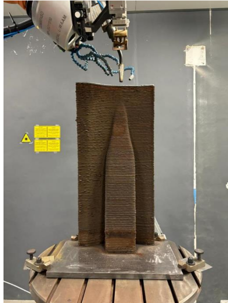
Figura 1. Demostrador Molde Acero/Invar fabricado mediante tecnología L-WAAM en las instalaciones de BEZZIER.
